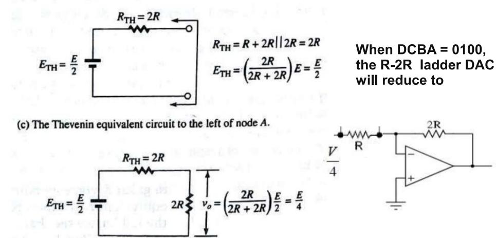
(d) Calculation of  $v_o$  using the voltage-divider rule.
